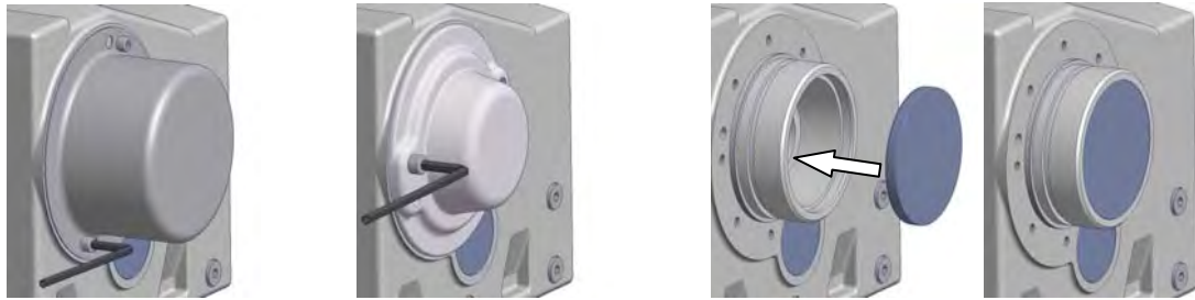
Bild 3-12: Montage der Abdeckhaube Option SH, Option H und Option H66
